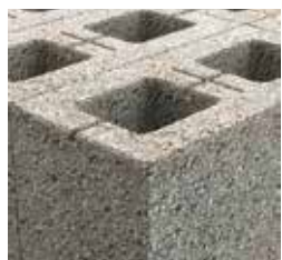
Tullë me vrima nga betoni i lehtë
